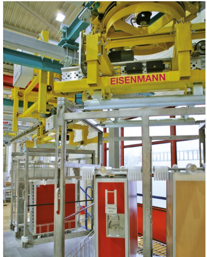
通过工作位置的旋转站可直接触及吊具的两侧。
