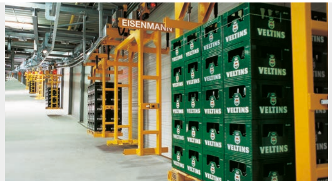
运输货物稳定安全，而且可在 45° 的斜度上运输。
