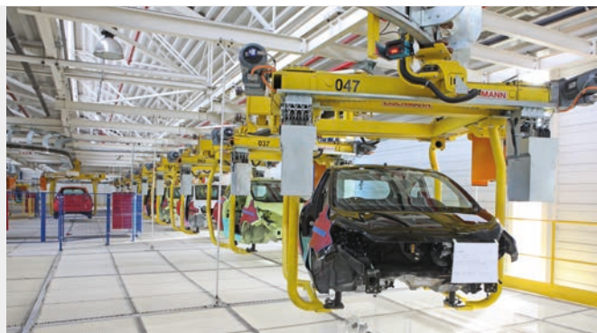
链式升降装置结构紧凑，在天花板高度较低时，此装置是首选。
