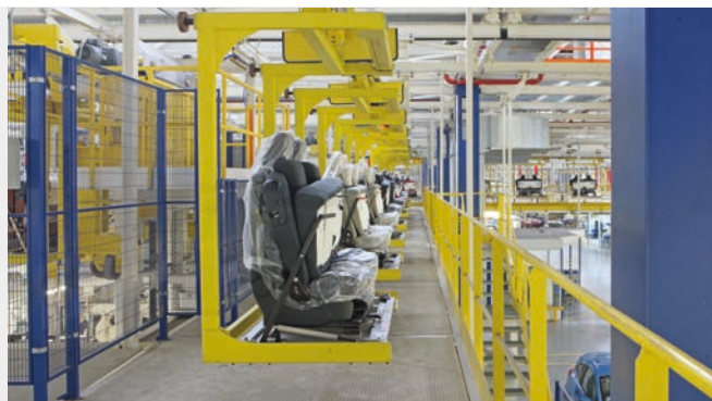
将座椅组供给最终装配生产线。
