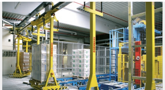
电动悬挂系统和电动地面轨道系统是以任务为导向的运输工具，具有极大的灵活性和高度的智能化。
