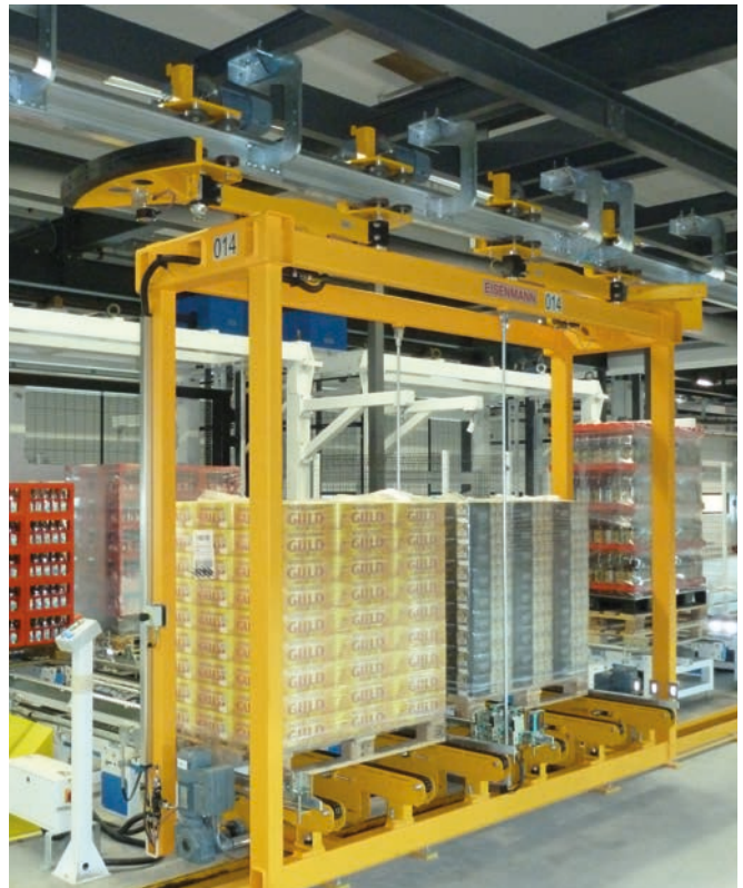
经由并行托盘移交达到最大输送量。
