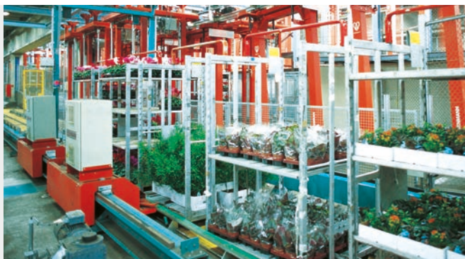
我们的地面输送技术设备实现了带滚轴的容器的自动化搬运。
