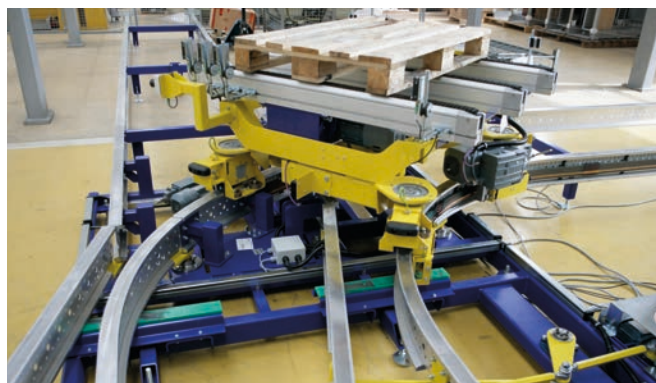
精心设计的道岔技术允许支路连续通行。
